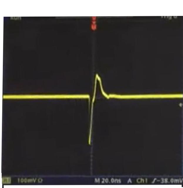
**Fig.4.42 ID281SNSPD real pulse**
